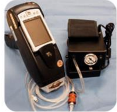
2002 NASA vacuum instrument 미 NASA와 공동으로 세계 최초의 경금속 분석용 휴대용 성분분석기 개발
