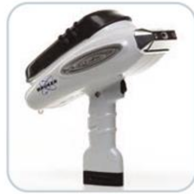
2008 S1 TURBO SD 세계 최초의 SDD 검출기 장착 휴대용 성분분석기 S1 TURBO 개발
